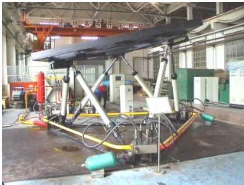
世界首台计算机直接控制的数字式六自由度运动平台 (用六只数字缸构成——无任何传感器和伺服阀)
